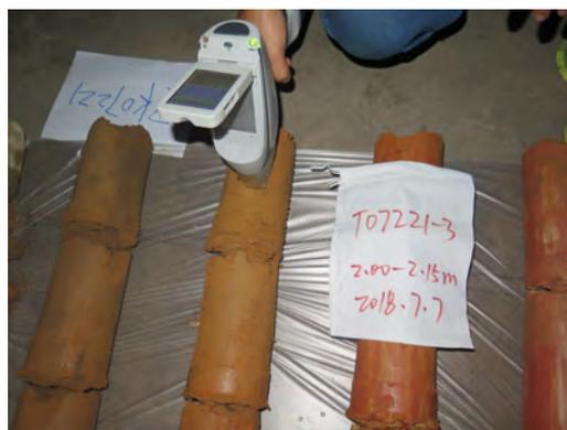
照片 5-2 土壤样现场 XRF 检测
