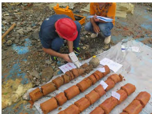
照片 5-1 土壤样现场 XRF 检测
