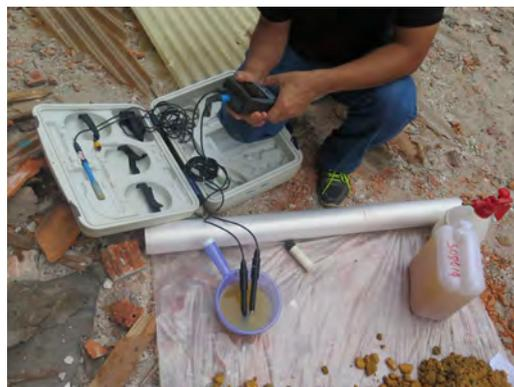
照片 5-4 地下水现场检测
